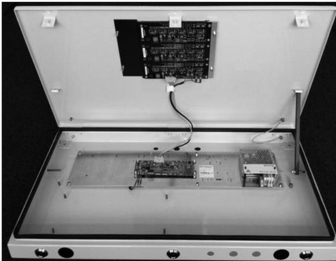
Basculez le filtre avant vers le haut et arrêtez-le avec la béquille se trouvant sur le côté droit de l'appareil.
